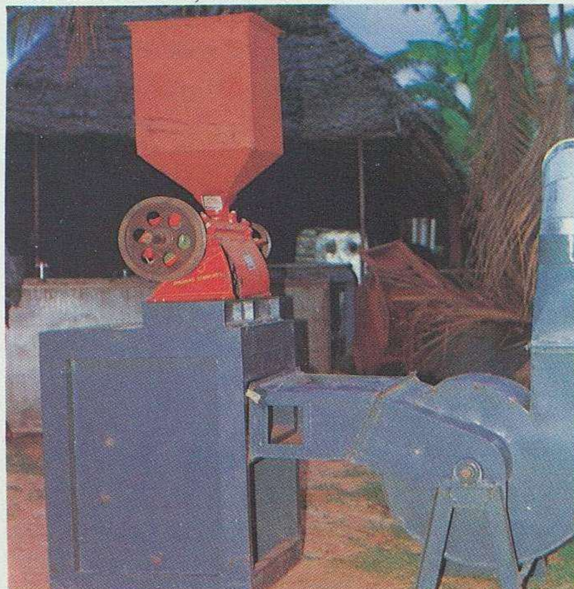
ग्रामीण क्षेत्रों के लिए एक आधुनिक लघु चावल मिल। A modern mini rice mill for rural areas.
