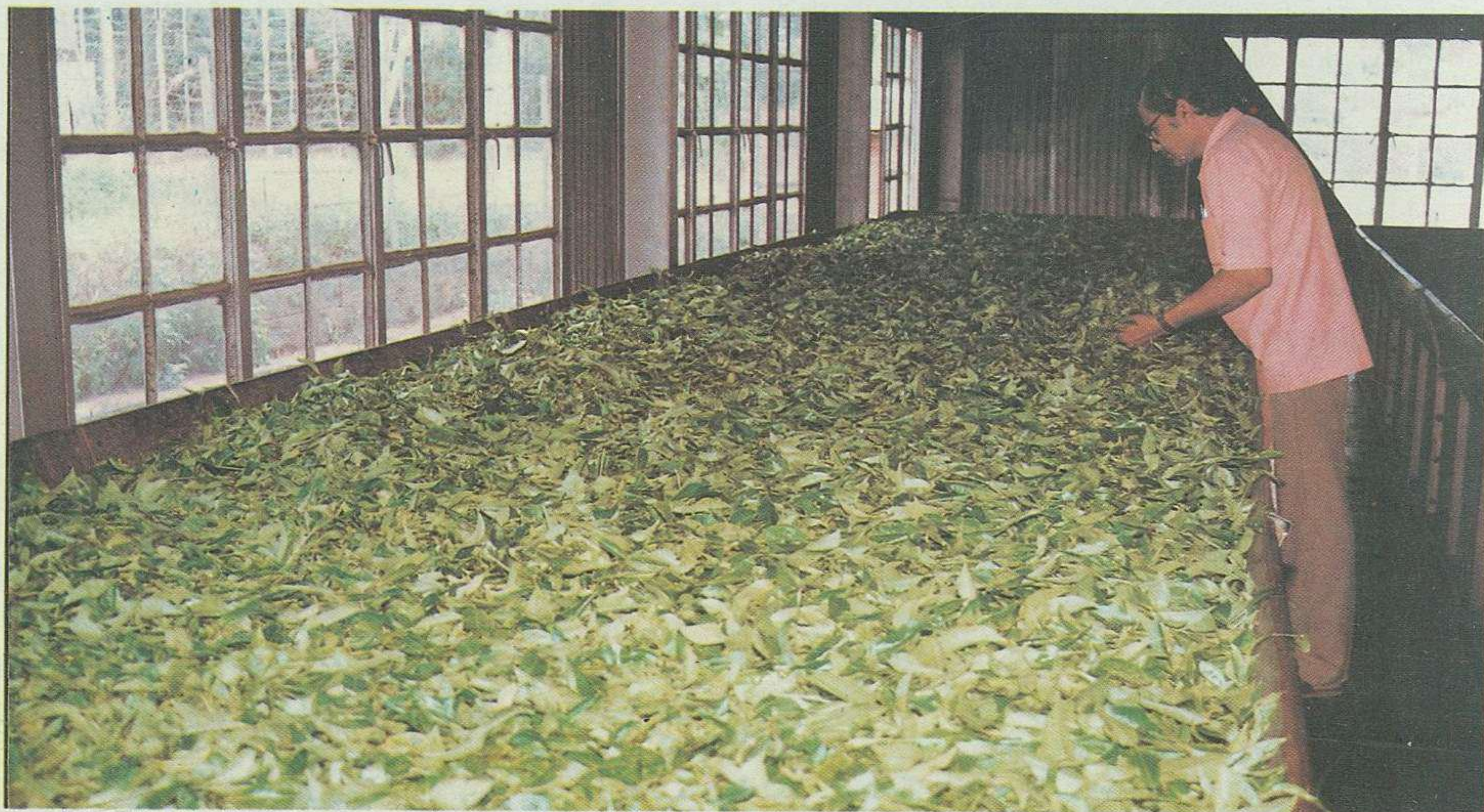
सौर गर्म हवा के इस्तेमाल से चाय पत्तियों का सूखाना Withering of Tea Leaves using solar hot air
